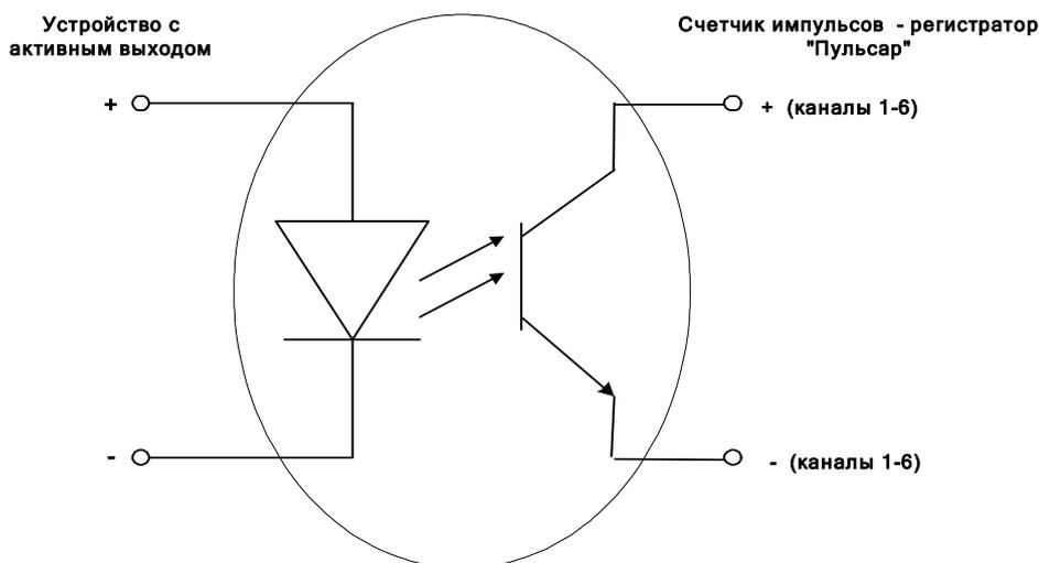
Рис. 7.1 Схема подключения устройств с активным выходом
