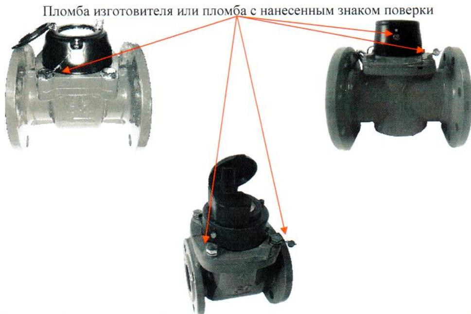
Рисунок 8 – Схема пломбировки счетчиков модификаций СТВХ и СТВУ
